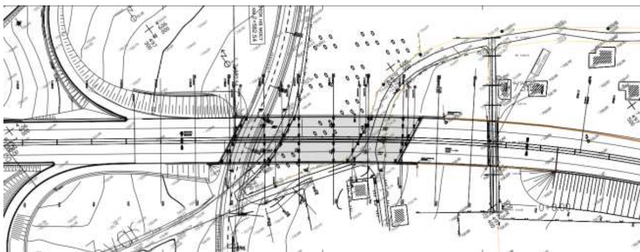
Слика 4-2 – Проектно решение за вијадуктот кај клучката Строгомиште: варијанта 0
