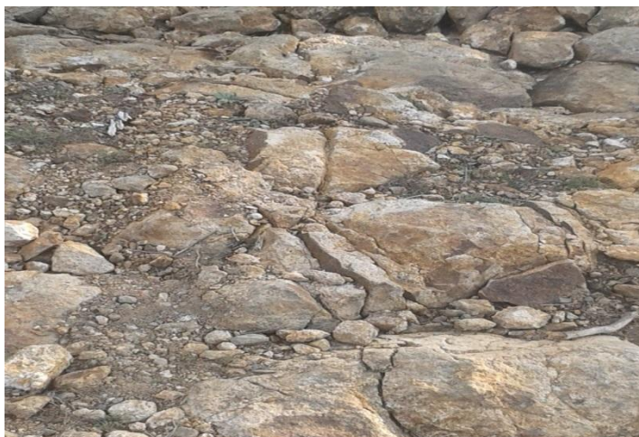
Слика 21 Туфови што се среќаваат на стационожа 0+800 до 1+850км, 2+150 до 3+725км и 6+445 до 7+060км
